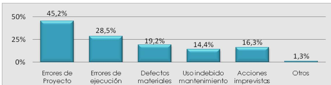
En cuanto a los porcentajes sobre los elementos estructurales y constructivos afectados en edificación con estructura de hormigón, se obtiene:
