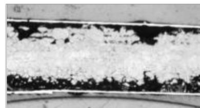
b) La corrosión por picado se manifiesta por puntos aislados de pequeña superficie, que se propagan hacia el interior mediante canales cilíndricos perpendiculares a la superficie.
