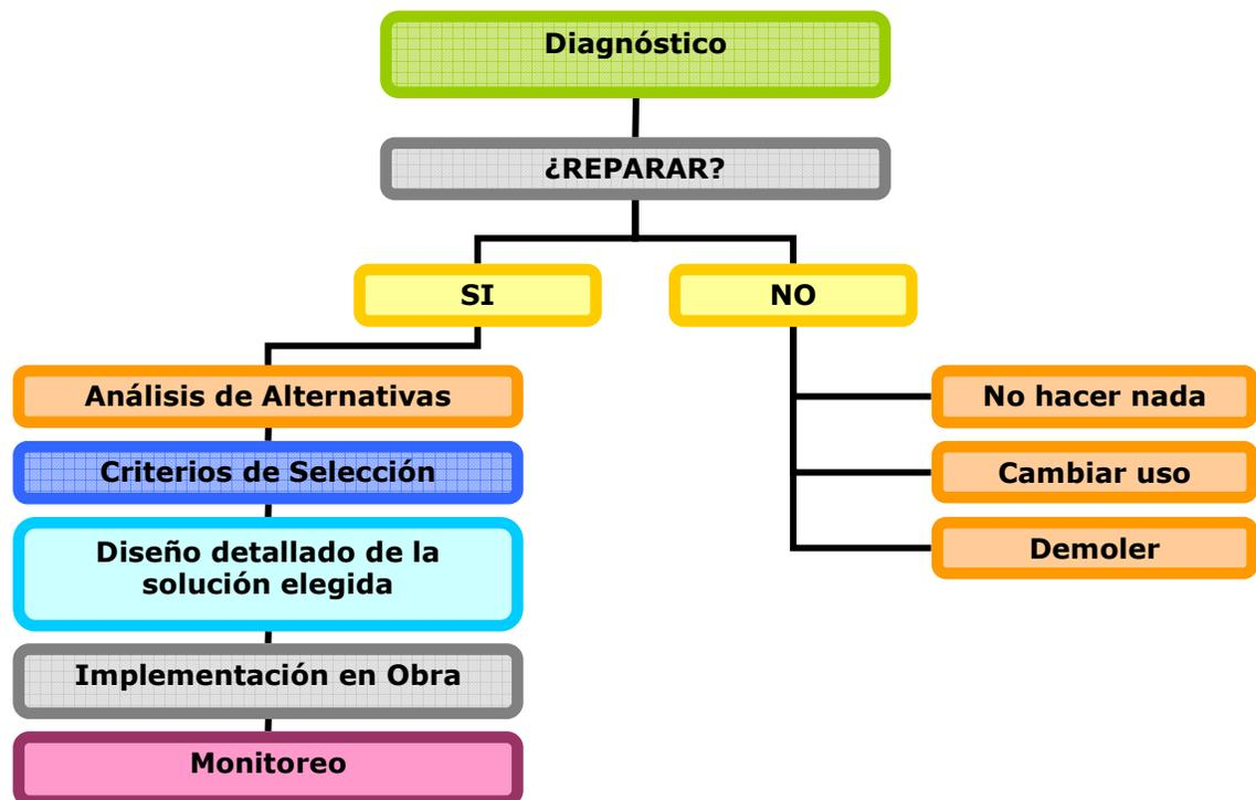
Figura 5.2: Diagrama a seguir para la reparación de estructuras.
