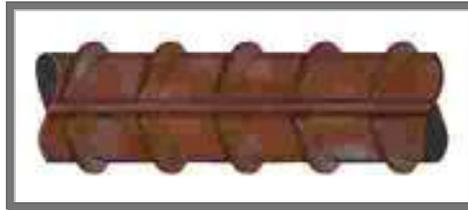
*Figura 3.5: Corrosión de la armadura: Nivel de daño moderado.*
