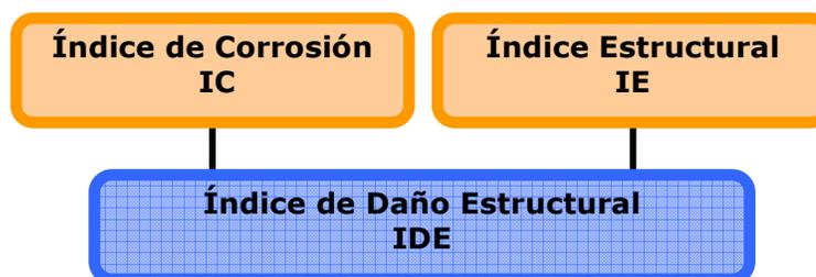
Figura 4.1: Cálculo del Índice de Daño Estructural.
