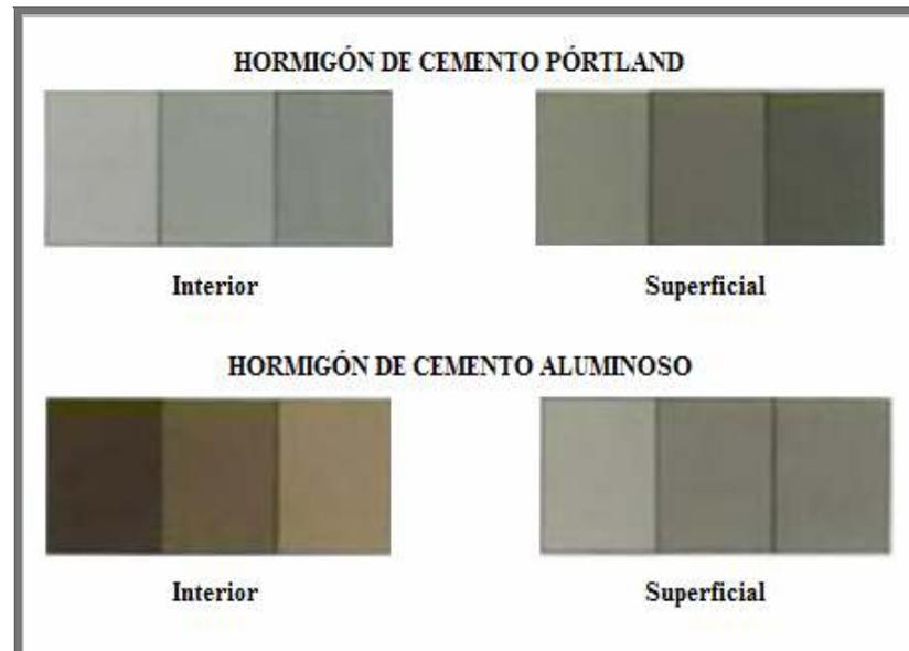
*Figura 3.2: Coloración Superficial e Interior que adopta el hormigón de acuerdo al tipo de cemento utilizado.*
