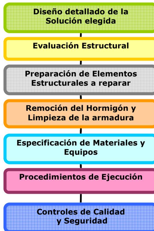
*Figura 5.4: Etapas que constituyen un diseño detallado de la solución de un problema patológico en estructuras de hormigón armado.*
