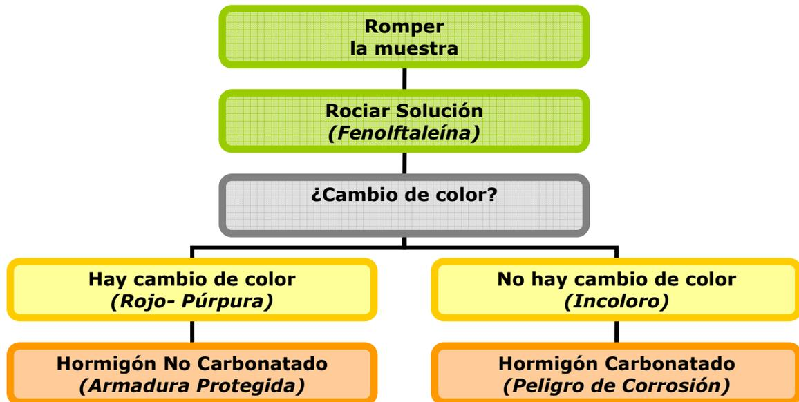
Figura A.3: Esquema del proceso para ensayo de carbonatación.
